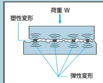
図-1 二面の接触における真実接触点
